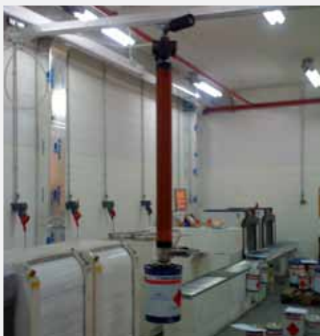
4. ATEX zone 1 installatie, VM120 met ejector, standaard zuigvoet art.nr. 630215.
