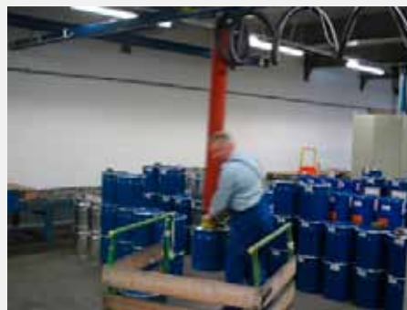
3. De VM160 wordt gebruikt voor het verplaatsen van vaten met een gewicht van ongeveer 60 kg. De standaard zuigvoet die
