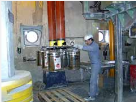
1. De VM2200 met speciale zuigvoet voor het gelijktijdig tillen van acht vaten met chemische substanties. Zuigvoet projectnr. 2578.
