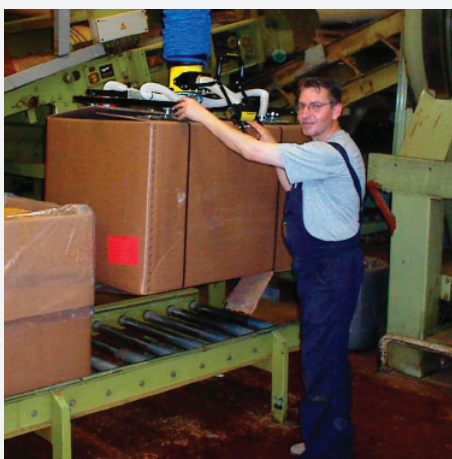
4. Grote dozen in de mechanische industrie worden gemakkelijk met de VacuEasylift getild.
