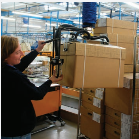
1. De flexibele, verlengde hendel verandert tillen "boven schouderhoogte" in ergonomisch tillen.
