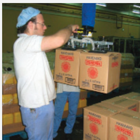
3. Gelijktijdig tillen van 2 dozen, speciale zuigvoet 2699.
