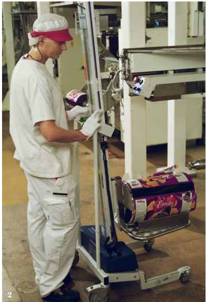
1–2. Het wisselen van een rol in een inpakmachine wordt soepel en veilig uitgevoerd, met het V-blok (rechts) en met een as (boven). Het V-blok is afneembaar, zodat het platform ook voor andere klussen, tussen wisselingen van de rollen door, gebruikt kan worden.
