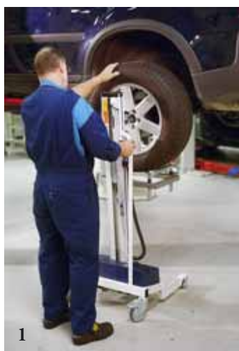
1. Kies een speciaal hulpstuk met geveerde rollen, om te helpen bij het demonteren van wielen.
