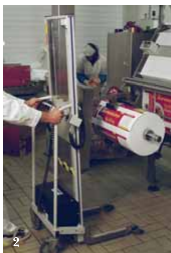
2. Een PRO100 met EasySqueeze en elektrisch draaien. De armen klemmen en draaien de rol van een verticale stand naar een horizontale inleg positie.
