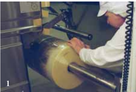
1–2. Het wisselen van een rol in een inpakmachine wordt soepel en veilig uitgevoerd, met het V-blok (rechts) en met een as (boven). Het V-blok is afneembaar, zodat het platform ook voor andere klussen, tussen wisselingen van de rollen door, gebruikt kan worden.
