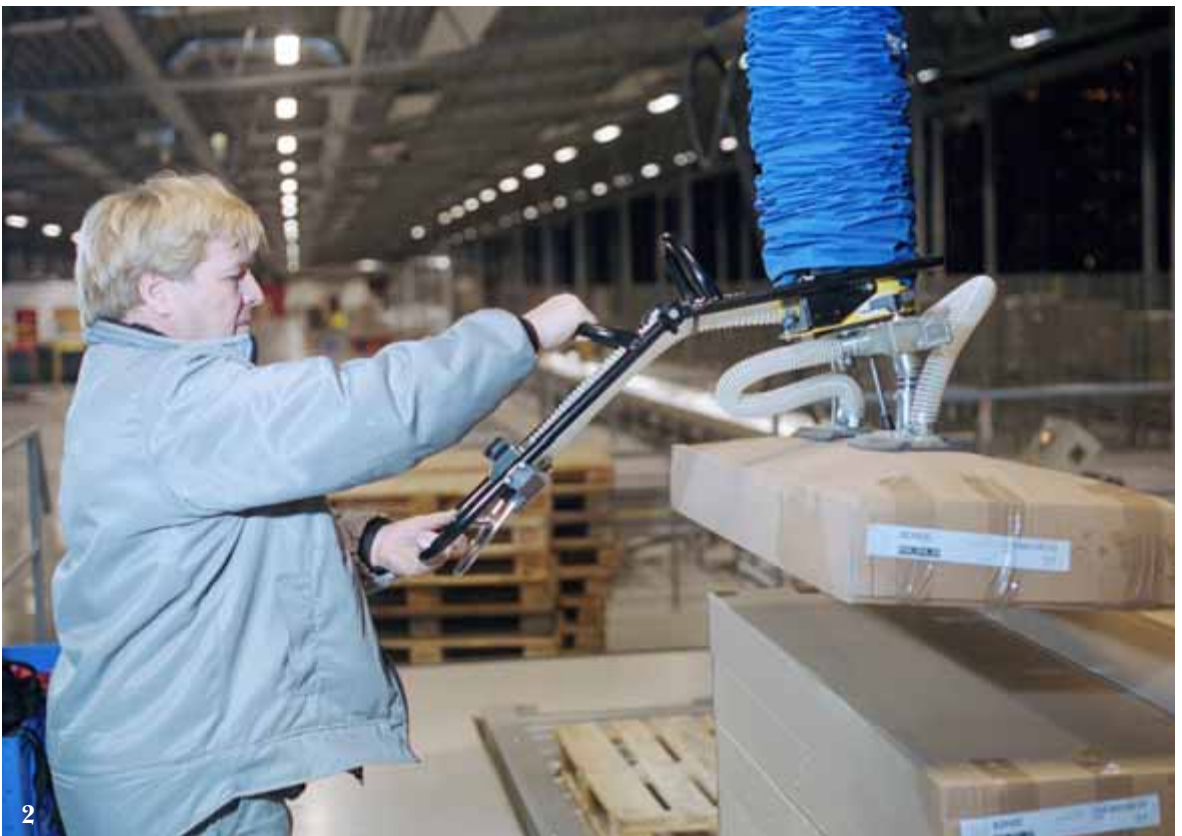
2. Het tillen van vlakke zware dozen komt zeer regelmatig voor. Indien nodig kan er een speciale hefbus worden geleverd waarmee een grotere werkweg word bereikt. Tevens inzetbaar bij een beperkte plafondhoogte.
