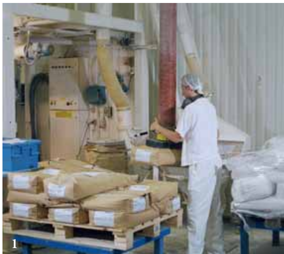
1-2. Het handmatig tillen van zakken is extreem zwaar en staat daarom in de VacuEasylift top 10 van de meest populaire toepassingen. De VM 160 kan zakken tot 60 kg tillen, genoeg om bijna alle zakken die gebruikt worden in de voedingsmiddelen- en chemische industrie te heffen.
