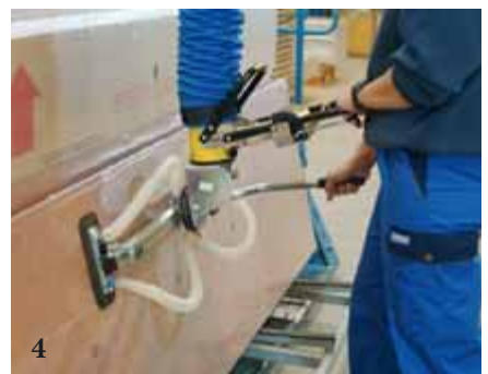
3-4. Dit systeem bedekt een gebied met in totaal 5 werkstations. Een hoekadapter met hendel wordt gebruikt om de zuigvoet 90 graden te kantelen zodat men de panelen van vertikaal naar horizontaal kan positioneren.
