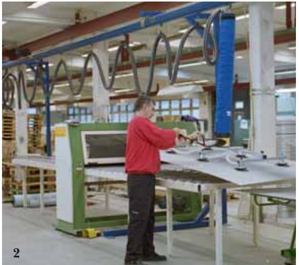
2. Deze grote en erg dunne platen gaan door de film-coating machine worden daarna opgepakt door een zuigvoet met 6 zuignappen. De rechte lijn waarin het product getransporteerd wordt is ideaal voor een Lyftman monorail.
