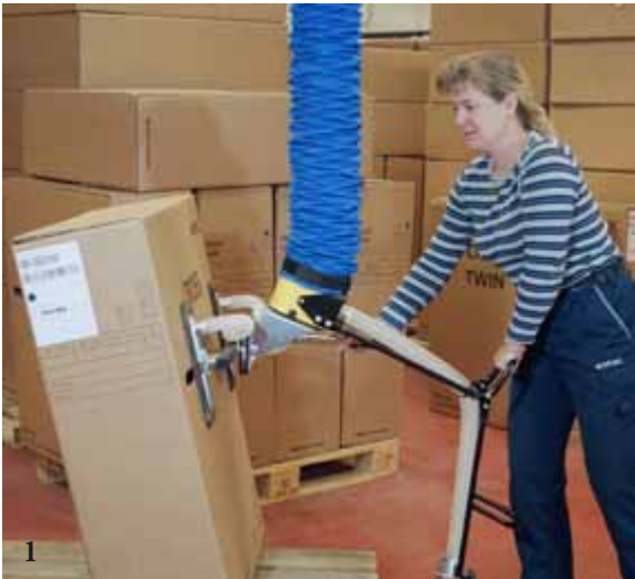
1–2. Een hoekadapter met hendel lost het probleem van vertikaal naar horizontaal vertikaal heffen.
