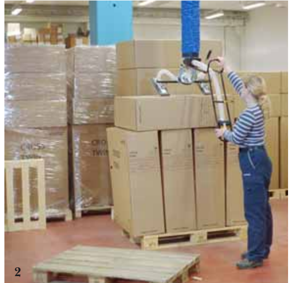
1–2. Een hoekadapter met hendel lost het probleem van vertikaal naar horizontaal vertikaal heffen.
