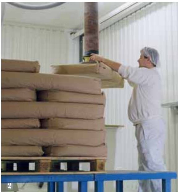
1-2. Het handmatig tillen van zakken is extreem zwaar en staat daarom in de VacuEasylift top 10 van de meest populaire toepassingen. De VM 160 kan zakken tot 60 kg tillen, genoeg om bijna alle zakken die gebruikt worden in de voedingsmiddelen- en chemische industrie te heffen.
