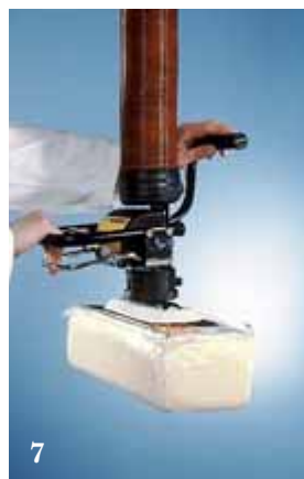
6-7. De VM 80 kan met 1 vinger bediend worden en heeft een maximaal hefvermogen van 20 kg. Deze is o.a. geschikt in de voedingsmiddelen- en elektronische componentenindustrie. Men eiste een extreem licht en snel systeem dat bij alle productielijnen ingezet kan worden. Dit resulteerde in 2 versies van de VM 80.
