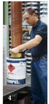
4. Een VacuEasylift voor het tillen van vaten, emmers en blikken is een populair hefsysteem in de farmaceutische en chemische industrie. We leveren zuigvoeten voor het heffen van 1 of meer blikken tegelijk.
