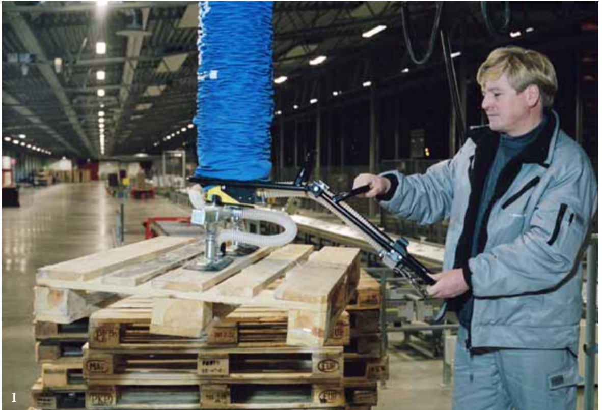
1. Deze zuigvoet kan worden gebruikt voor het tillen van dozen en pallets. Hier worden eerst de dozen van de pallets af getild om daarna de pallet te verplaatsen.
