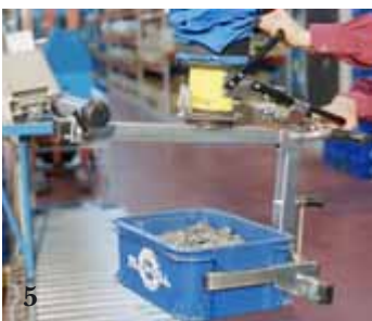
5. Een VacuEasylift met een speciale gripper voor het heffen van kratten. Deze unit is uitgerust met een snelwisselsysteem, zodat met snel kan wisselen van kratten-zuigvoet naar dozen-zuigvoet.
